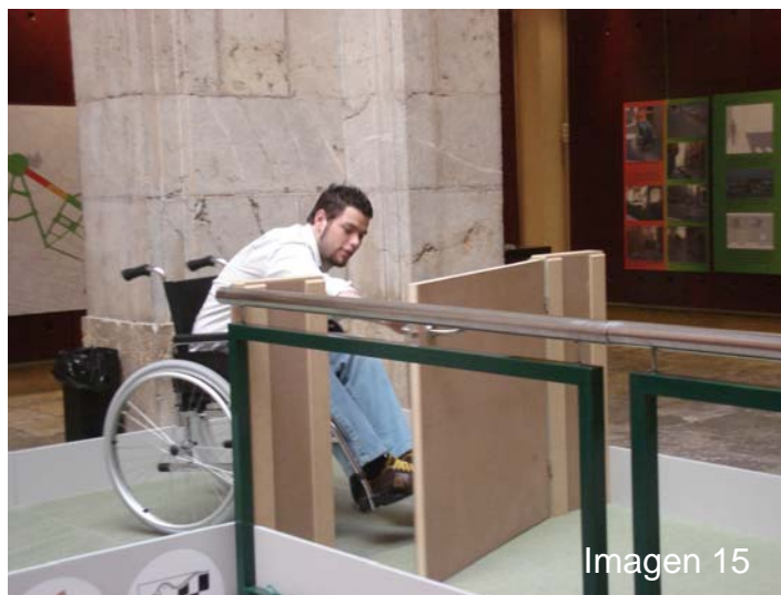
Imagen 15 : Observamos que la puerta es accesible porque el pomo es accesible y se abre hacia delante.
