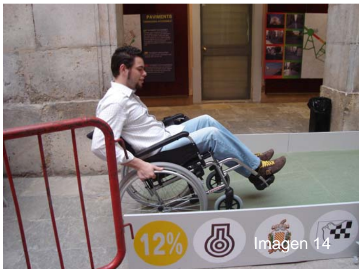
Imagen 14 : Esta rampa es accesible porque la pendiente no supera el 12%.
